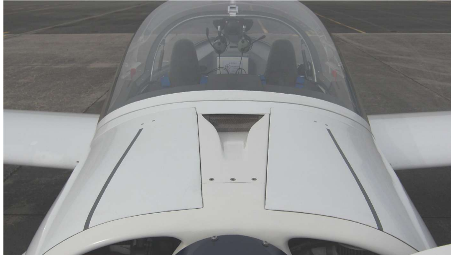
Abb.22 NACA-Lufteinlaß auf Motorhaube für Frontbelüftung der Kabinenhaube
