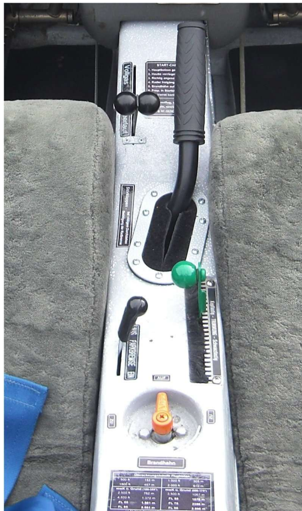
Abb. 12 Trimmhebel (grün) mit Rastenblech auf Mittelkonsole
