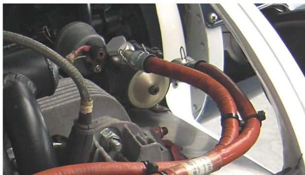
Abb.29 mechanische Kraftstoffpumpe am Motor rechts vorn
