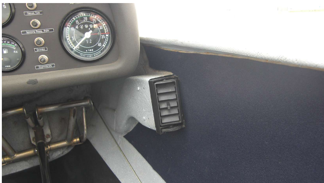
Abb.21 Kaltluftdüse mit Auslaßregelung beim rechten Piloten
