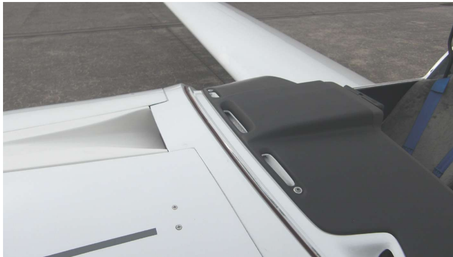
Abb.23 Belüftungsdüsen der Kabinenhaube auf dem I-Brett
