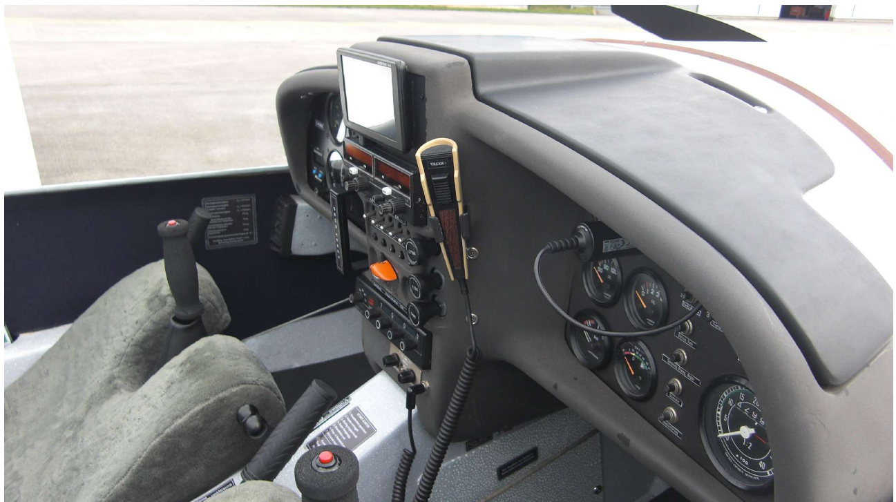
Abb.17 Handmikrofon angestöpselt und in Bereitschaftshalterung eingehängt
