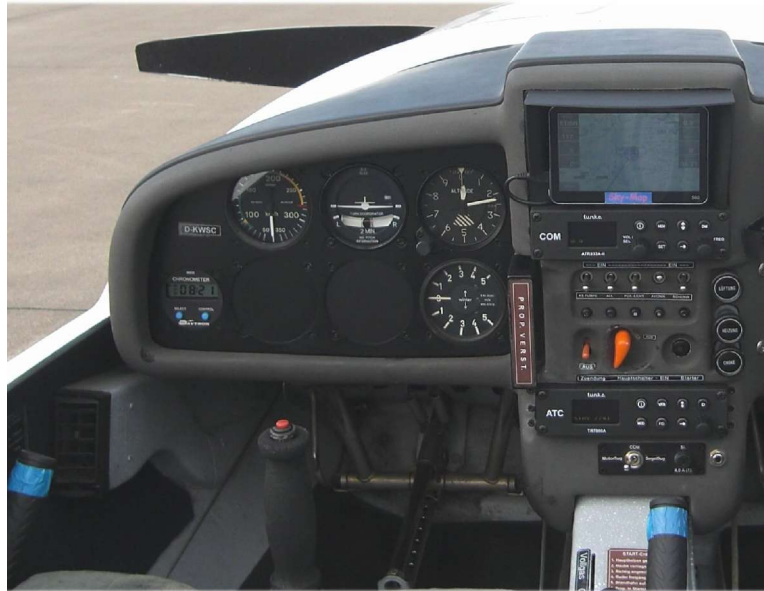
Abb.13 Anordnung der Fluginstrumente auf dem linken Instrumentenbrett
