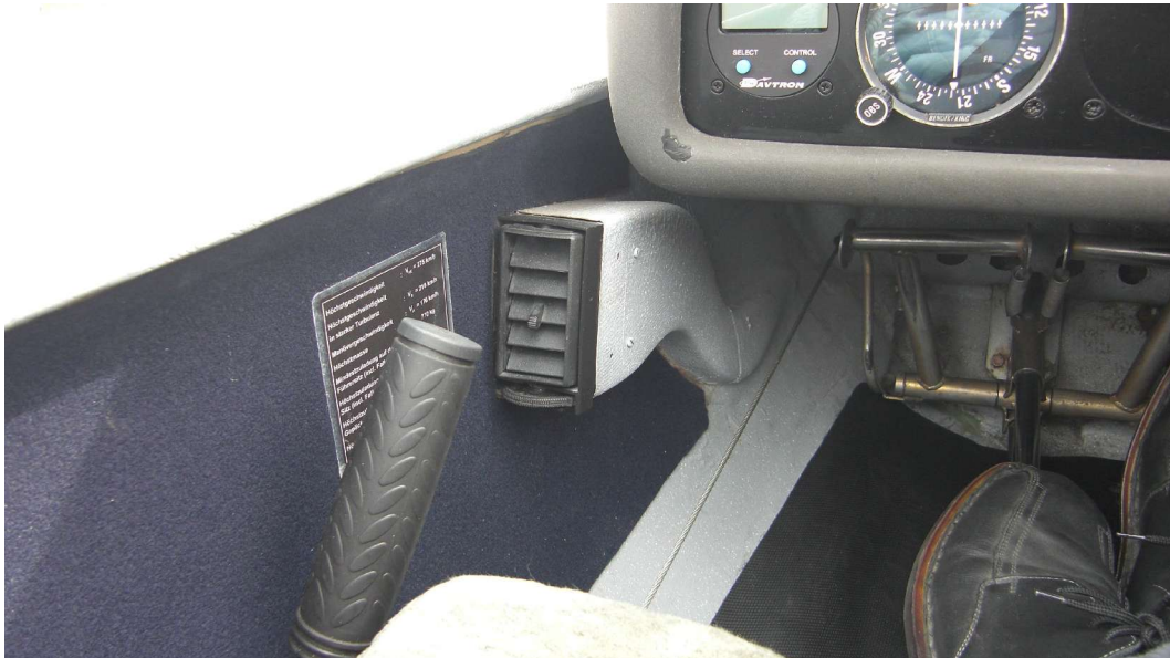
Abb.20 Kaltluftdüse mit Auslaßregelung beim linken Piloten
